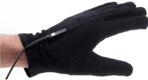
Der Biegesensor ist in Buchse 1 zu stecken. Der Sensor kann in die Lasche auf dem Fixierhandschuh geschoben werden, achten Sie dabei darauf, dass die Beschriftung „UP“ nach oben zeigt und sichtbar ist.
