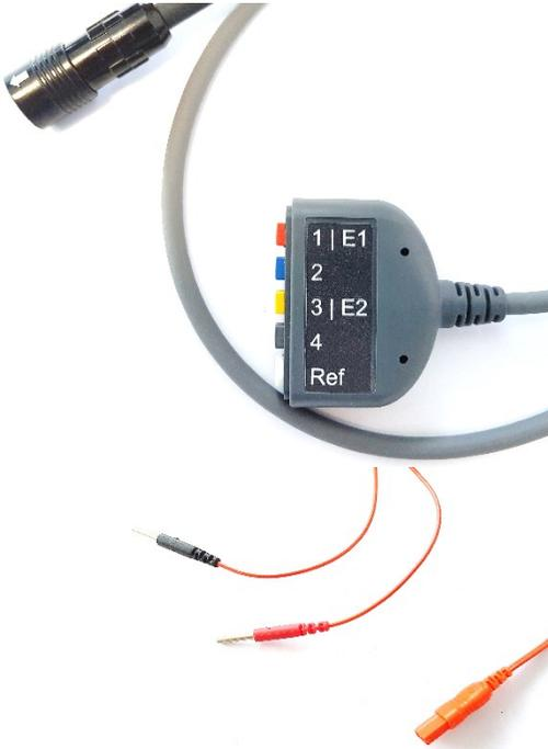
Das Hauptkabel ist in die Buchse 2 für Elektrodenkabel zu stecken. Die einzelnen Elektrodenkabel können entsprechend ihrer Farbe mit dem Hauptkabel verbunden werden. Das Referenzkabel wird in die weiße Buchse gesteckt.
